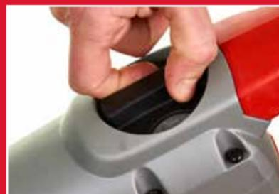
Funzione roto-stop e possibilità di regolare l'angolazione dello scalpello
